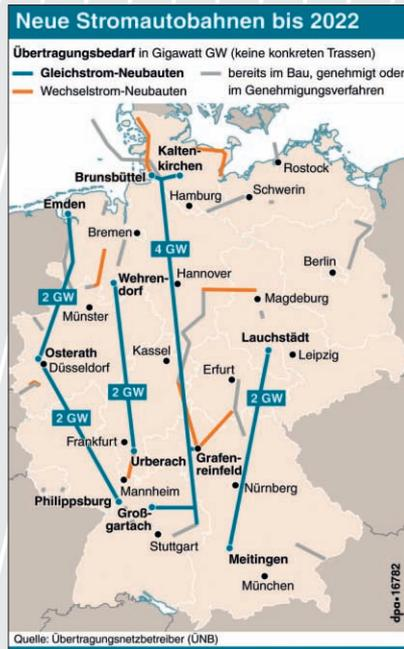
**Übertragungsbedarf im deutschen Stromnetz bis 2022 – benötigte Neubauten von Gleichstrom- und Wechselstromleitungen**
