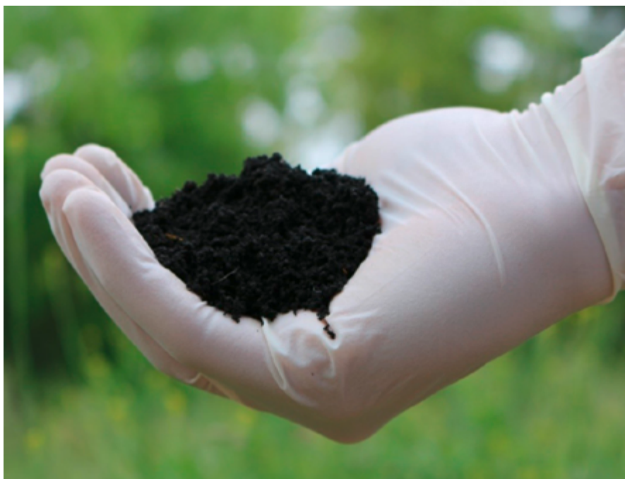
Abb. 2: Klärschlamm nach der Entwässerung
